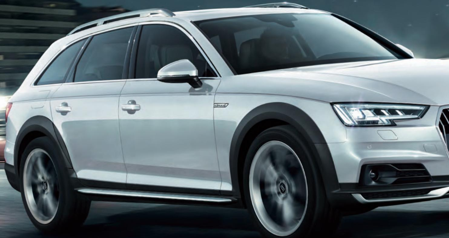
エンジン&ドライブトレインともに進化を遂げたAudi A4 allroad quattro。高出力と高効率を両立させた最新世代のTFSI®エンジンが、走りを加速するテクノロジーと効率性の向上を比類無いレベルで実現しました。また、新開発された4WDシステムquattroは、電子制御油圧多板クラッチにより前後アクスルへトルクを最適に配分。システムが4WD走行が不要な状況と判断した場合、前輪のみにトルクを配分しFFに切り替えます。これにより、走行抵抗を軽減し燃費向上を図っています。またAudi A4 Avantよりも最低地上高を高く設定し、無舗装路などでのロードクリアランスを確保。オンロード、オフロードを問わず、様々な走行シーンにおいて快適で優れたドライビングフィールを実現し、尽きることの無い悦びをもたらします。
