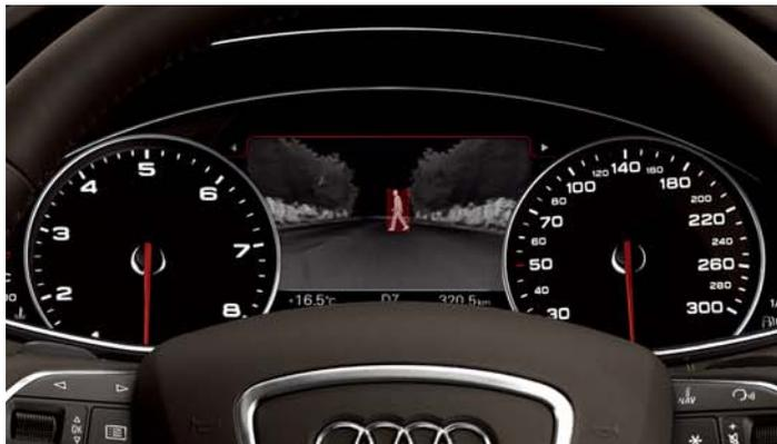
「目」は最も精密な器官の一つですが、暗闇や目が眩んだ瞬間などに大切な物を見落としてしまう可能性があります。そのような状況に対応するために、ナイトビジョン システムをオプション設定しています。夜間の運転視界を広げるナイトビジョン システムは、暗闇に潜んで見えない歩行者を早いタイミングで発見するためのアクティブセーフティシステムです。この先進のシステムは、夜間でも赤外線カメラにより物体から放射される熱（遠赤外線）を感知。15～100m 先までの歩行者の体温を視覚化できます。その画像を「人」を識別するソフトウェアを組み込んだイメージプロセッサで処理した上で、メーターパネル内のディスプレイに映し出してドライバーに知らせます。
