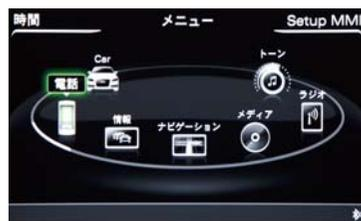
**TEL:** Bluetoothにより携帯電話の接続がされている場合、起動時の選択画面にアドレス帳や様々なリストが表示されます。
