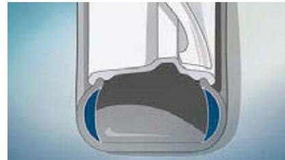
**ランフラット・タイヤ\***：タイヤのサイド・ウォールを強化しているため、パンクした場合でも、タイヤが完全につぶれたり、リムから外れたりすることがなく、一定距離を走り続けることができます。空気圧の低下を感知すると、点灯してドライバーに知らせるタイヤ空気圧警告システムも装備。
