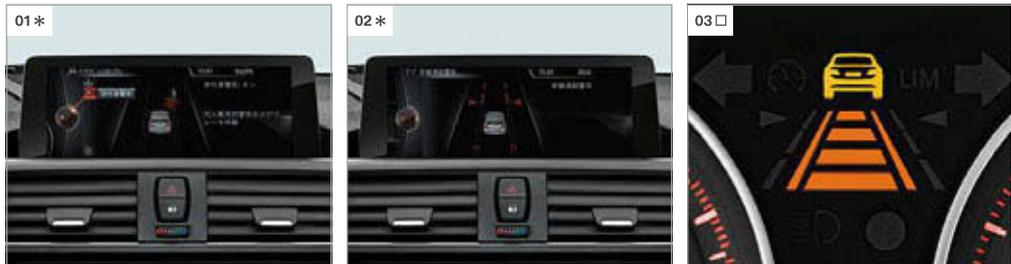
**【01】02】** **ドライビング・アシスト**(レーン・デパーチャー・ウォーニング(車線逸脱警告システム)、前車接近警告機能、衝突回避・被害軽減ブレーキ)<sup>\*1\*</sup>\*2: 前車接近警告機能は、常に前方をモニターしており、先行車に接近すると、まず予備警告として、メーター・パネルの警告灯で注意を喚起します。急速に接近した場合は緊急警告が作動し、警告音を発して、衝突を避けるように強く促すとともに、システムが予めブレーキ圧を高め、ドライバーのブレーキ操作時に瞬時に最大の制動力を発揮できるように備えます。ステアリングやブレーキの操作など、ドライバーによる事故回避行動がないまま、衝突が不可避と判断された場合、システムが自動的にブレーキをかけて先行車との衝突回避・被害軽減を図ります。この衝突回避・被害軽減ブレーキは、歩行者に対しても作動します。レーン・デパーチャー・ウォーニングは、車線からクルマが逸脱しようになると、ステアリング・ホイールを振動させてドライバーに注意を促します。
