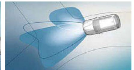
**アダプティブLEDヘッドライト\*1**：コーナーに進入した際、ヘッドライトの角度を自動制御し、車が曲がる方向を照射して安全性を高めます。またバリアブル・ライト・コントロール機能が走行速度に応じてヘッドライトの照射範囲や到達距離を調整し、ドライバーに最適な視界を提供。さらに、フォグ・ランプ\*2がコーナリング・ライト\*2として機能し、ターン・インジケータと連動して曲がる方向を明るく照らします。
