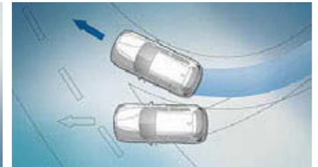
**DSC(ダイナミック・スタビリティ・コントロール)**：高精度センサーが車両の状態をリアルタイムでモニターし、必要に応じて各ホイールへのブレーキ入力やエンジン出力を制御することにより、走行安定性とトラクションを最適化し、安全性とドライビング・プレジャーを同時に高めることができます。
