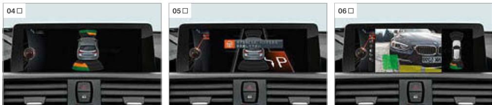
**【04】** **PDC(パーク・ディスタンス・コントロール)**: フロントおよびリヤ、またはリヤのみに装備可能。車両の前方や後方にある障害物までの距離を信号音とビジュアル表示で知らせ、狭いスペースでの駐車や車庫入れをサポートします。
