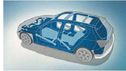
**パッセンジャー・セル**：衝突時の変形を精緻な計算により解析し、その結果をもとに高い剛性を誇る補強材や高強度素材を効果的に使用しました。前面・側面・後面からのいかなる衝突に対しても、最大限のパッセンジャー・セルの安全性を実現します。
