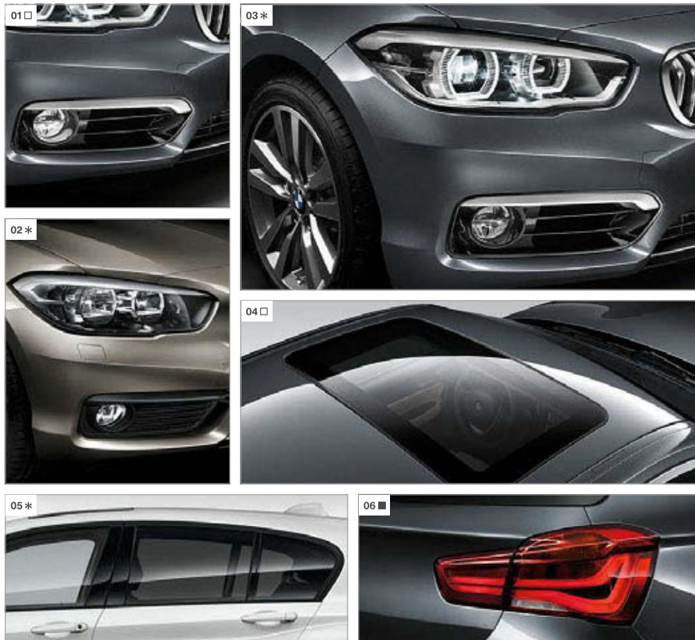
**【01】** **LEDフロント・フォグ・ランプ**: LEDヘッドライトやキセノン・ヘッドライトのカラーとマッチします。ホワイトの明るい光は、視界の悪い状況での安全性も向上させます。
