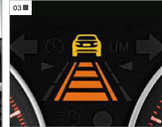
**[01][02]** ドライビング・アシスト(レーン・ディバーチャー・ウォーニング(車線逸脱警報システム)、前車接近警報機能、衝突回避・被害軽減ブレーキ)\*<sup>1+2+3</sup>\*：前車接近警報機能は、常に前方をモニターしており、先行車に接近すると、まず予備警報として、メーター・パネルおよびBMWヘッドアップ・ディスプレイ\*<sup>4</sup>の警告灯で注意を喚起します。急速に接近した場合は緊急警報が作動し、警報音を発して、衝突を避けるように強く促すとともに、システムが予めブレーキ圧を高め、ドライバーのブレーキ操作時に瞬時に最大の制動力を発揮できるよう備えます。ステアリングやブレーキの操作など、ドライバーによる事故回避行動がないまま、衝突が不可避と判断された場合、システムが自動的にブレーキをかけて先行車との衝突回避・被害軽減を図ります。この衝突回避・被害軽減ブレーキは、歩行者に対しても作動します。レーン・ディバーチャー・ウォーニングは、車線から黒マウルが逸脱しそうになると、ステアリング・ホイールを振動させてドライバーに注意を促します。
