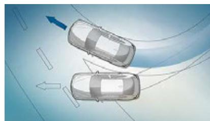
**DSC(ダイナミック・スタビリティ・コントロール)**：高速コーナリングの際にブレーキを最適に制御し、クルマの安定とコントロール性を維持するCBC(コーナリング・ブレーキ・コントロール)に加え、ハンドブレーキを用ひず急な坂道での発進をスムーズにする「スタート・オフ・アシスト」機能が装備されます。DSCは、スリップやスライドの兆候を感じ、クルマを安定させます。
