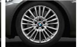
19インチ マルチスポーク・スタイリング 455 アロイ・ホイール：（フロント）8.5J× 19ホイール、245/40R19タイヤ、（リヤ） 9J×19ホイール、275/35R19タイヤ （ランフラット・タイヤ） ※ スノーチェーンは装着できません。
