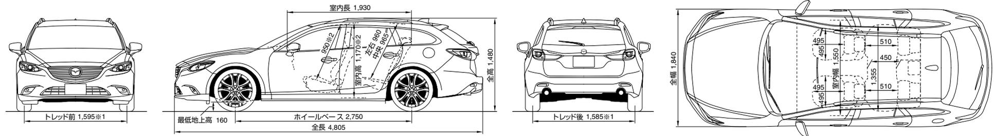
※1:225/55R17 97Vタイヤ&17×7Jインチアルミホイール装着車は、トレッド前1,585mm/後1,575mmとなります。※2:電動スライドガラスサンルーフ装着車は、ヘッドクリアランス920mm、室内高1,160mmとなります。
