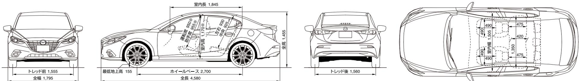
\*電動スライドガラスサンルーフ装着車は、ヘッドクリアランス運転席925mm/助手席930mm、室内高1,165mmとなります。
