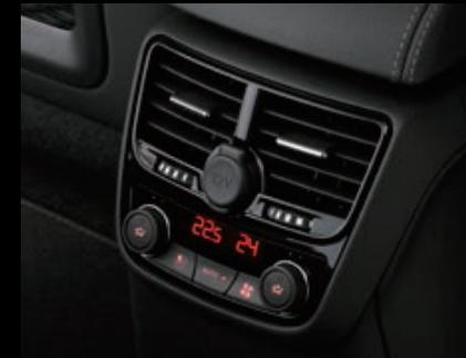
最新のシステムです。運転席、助手席、後席左右の2つのゾーンで、それぞれ自由にエアコンの設定が行えます。温度設定はもちろん、風量も調整可能。個々の乗員に快適な室内空間を提供します。
