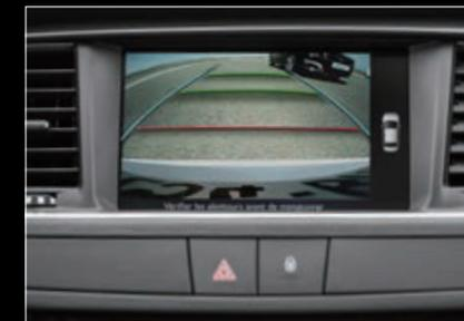
同時にリアバンパーに内蔵されたバックソナーが後方の障害物との距離を検知し、障害物に近づくタッチスクリーン上のスケールに警告を表示。さらに近づく警告音で知らせます。また前方の障害物を検知するフロントソナー\*も装備されています。 \*OrPTI NMS NDrPTI に標準装備
