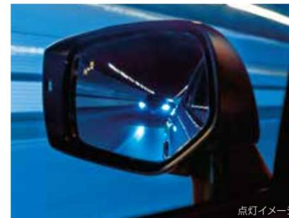
車体後部に内蔵されたセンサーによって、自車の後側方から接近する車両を検知。ドアミラー鏡面のLEDインジケーターや警報音でドライバーに注意を促します。
