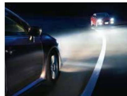
フロントウィンドウ内側の単眼カメラが前方の光を検知し、状況に応じてハイビーム/ロービームを自動的に切り替え。より明るく安全な夜間視界を確保します。
