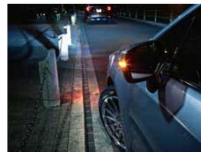
助手席側ドアミラーに装着されたカメラの映像をマルチファンクションディスプレイに表示。ドライバーからは死角となる自車の左前方の様子を確認できます。
