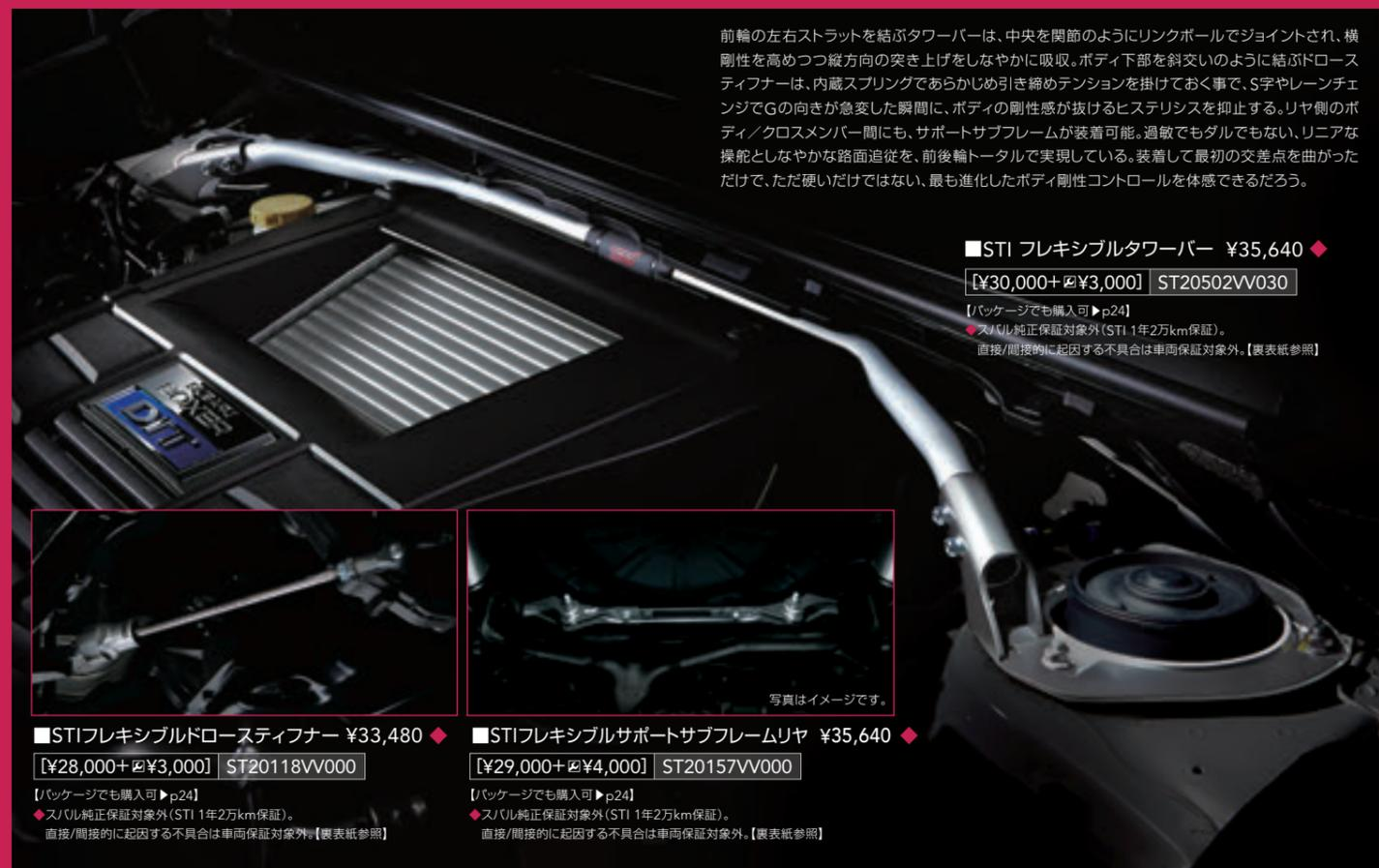
前輪の左右ストラットを結ぶタワーバーは、中央を関節のようにリンクボールでジョイントされ、横剛性を高めつつ縦方向の突き上げをしなやかに吸収。ボディ下部を斜交いのように結ぶドロースティフナーは、内蔵スプリングであらかじめ引き締めテンションを掛けておく事で、S字やレンチェンジでGの向きが急変した瞬間に、ボディの剛性感が抜けるヒステリシスを抑止する。リヤ側のボディ/クロスメンバー間にも、サポートサブフレームが装着可能。過敏でもタルでもない、リニアな操舵としなやかな路面追従を、前後輪トータルで実現している。装着して最初の交差点を曲がっただけで、ただ硬いだけではない、最も進化したボディ剛性コントロールを体感できるだろう。
