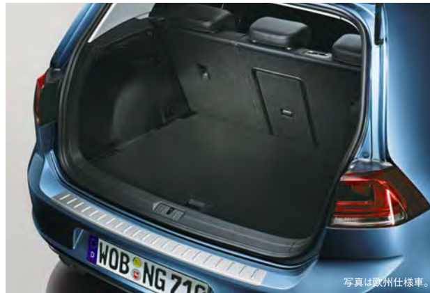
21 リヤバンパープレート ：荷物の出し入れなどによるバンパー上部の傷つきを防ぎます。
