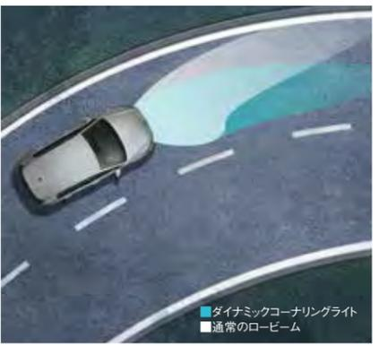
**ステアリングの動きに連動して照射。**
