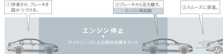
アイドリングストップ技術により、無駄な燃料の消費を抑えるシステム。信号の多い街中や渋滞時にクルマを停止させた際、ブレーキペダルを踏みつけると自動的にエンジンが停止。発進の際はブレーキペダルから足を離せばスムーズに再始動します。エンジンの自動停止はACC (アダプティブクルーズコントロール) やオートホールド、エレクトロニックパーキングブレーキの作動中でも行なえます。さらにアクセルオフやブレーキ操作などによる、停車に向けた制御の実行中にも自動停止が可能です。
